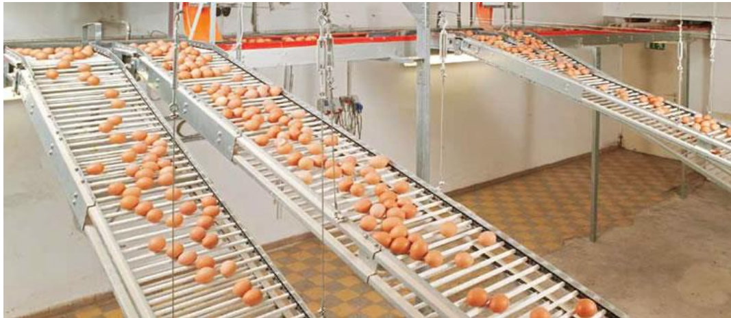
Slika 22.: Sustav transporta jaja u peradarniku
