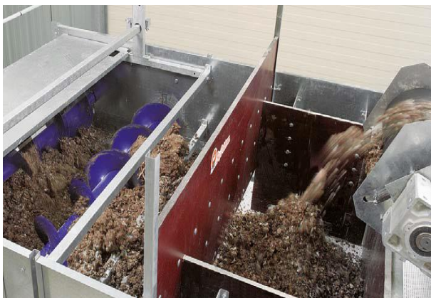
Slika 13.: Uređaj za usitnjavanje gnoja
