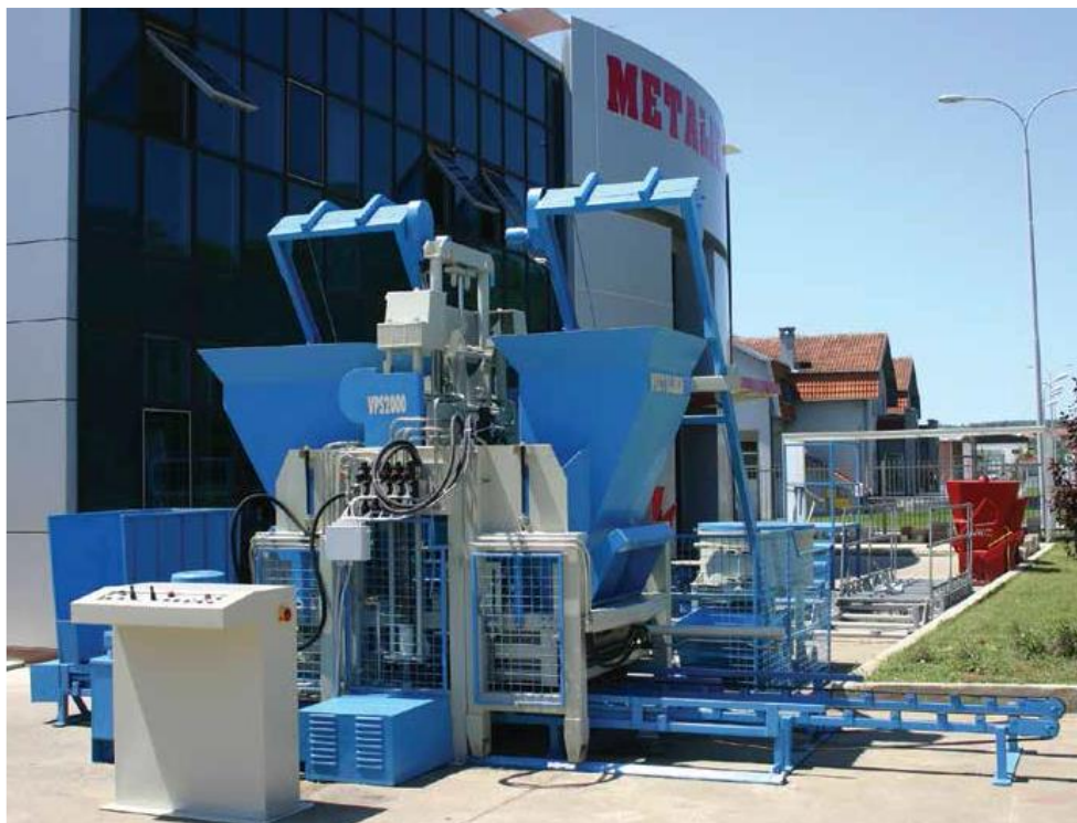
Slika 2.2 Automatski stroj za proizvodnju betonskih elemenata VPS 2000 s liftovima, linijom za povratak paleta i stanicom za pakiranje gotovih proizvoda (izvor: www.metallika.rs )
