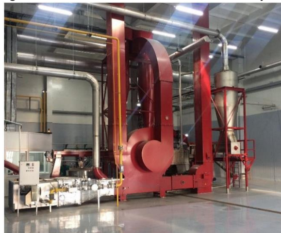
Primjer Ringdryer-a (Izvor: nositelj zahvata)
