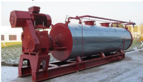
Primjer destruktora i preše za masnoću (Izvor: nositelj zahvata)
